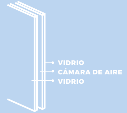
Figura 16: Acristalamiento doble o aislante a la conducción con cámara de aire. Elaboró: ASK-MMD.
