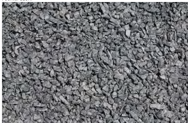
Imagen: Piedra triturada como material permeable en vialidad Fuente: 123RF
