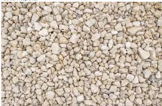
Imagen: Grava como material permeable en vialidad Fuente: Freepick.es
